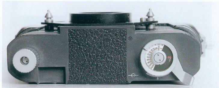
*Alpa 11mE (Mercure) in finiture nere – solo corpo senza specchio e senza obiettivo ma con innesto a vite – vista del tettuccio – si nota l'assenza del mirino e la velocità di otturazione di 1/60 oltre alla posa T.*
