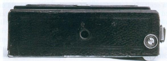
Fotocamera Bergheil 9x12cm - Il fianco destro con la maddrevite ed il bottone per l'apertura del pannello frontale.
