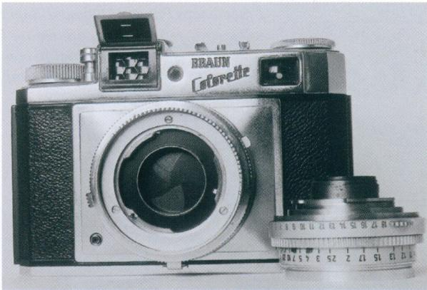
Fotocamera Colorette Super IIB con telemetro, esposimetro, otturatore Synchro Compur, obiettivi intercambiabili con baionetta Synchro Compur, con obiettivo smontato (vista frontale)
