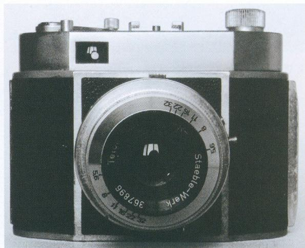
*Fotocamera Neidig Perlux senza telemetro con obiettivo Telon 85mm f/5.6 (vista del frontale).*
