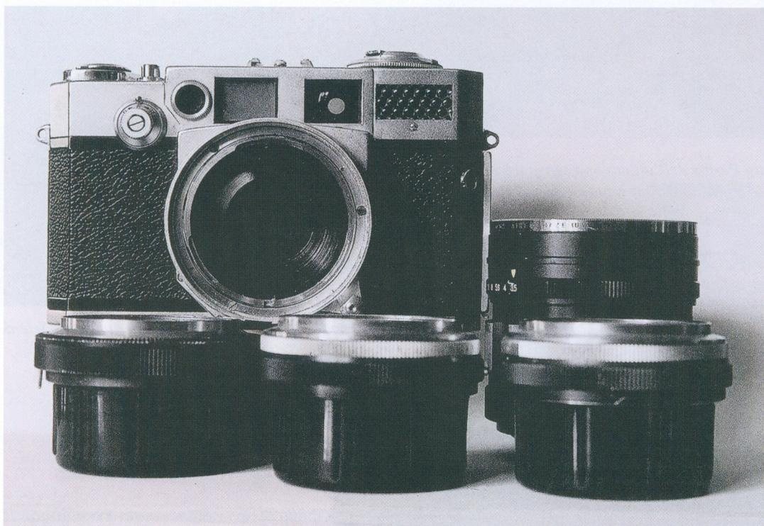
*Fotocamera Aires 35V del 1958 con telemetro accoppiato, cornici, esposimetro al selenio, otturatore a lamelle Seikosha MX da 1/500 ed obiettivo intercambiabile ^ solo corpo senza obiettivo con il corredo ottico completo*
