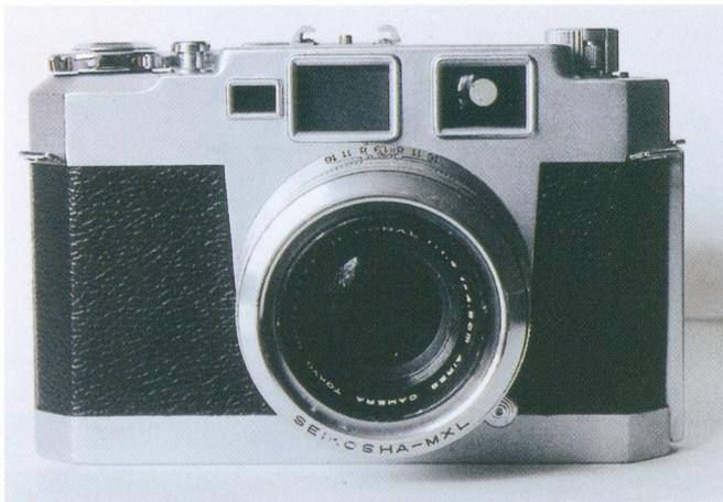
Fotocamera Aires III L del 1957 con telemetro accoppiato ed obiettivo non intercambiabile H Coral 45mm f/1.9 su otturatore Seikoshia MX da 1/500 (vista frontale)
