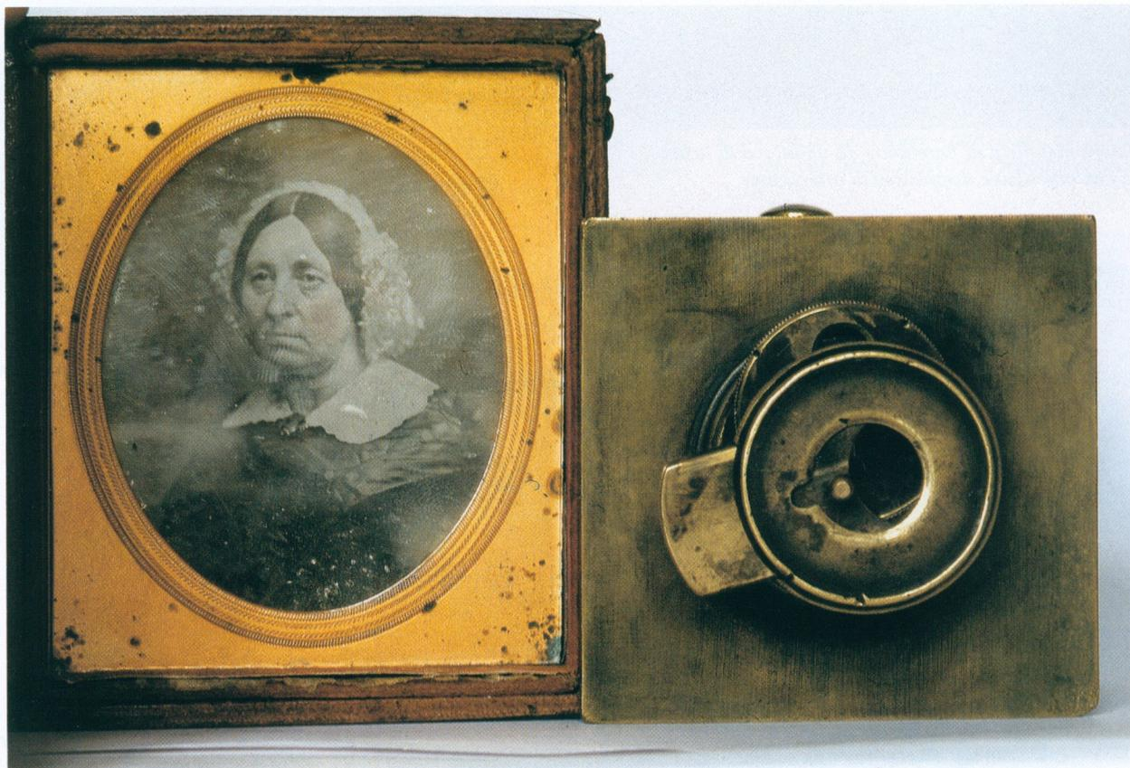
*Fotocamera Lerebours con un dagherrotipo di formato analogo a quello della fotocamera.*
