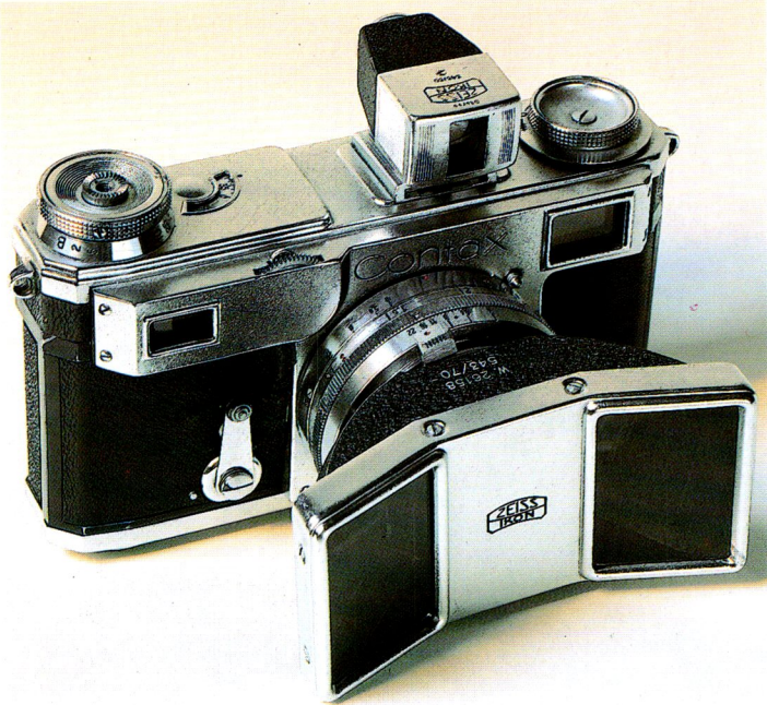
Gruppo stereo anteguerra montato su Contax II.
