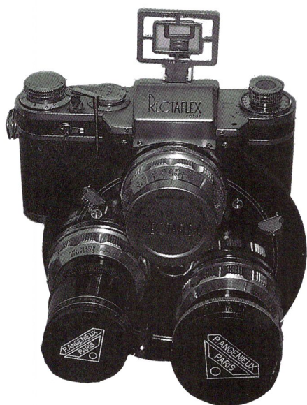
Rectaflex Rotor, torretta per tre ottiche. Rectaflex Rotor, three lens rotating plate
